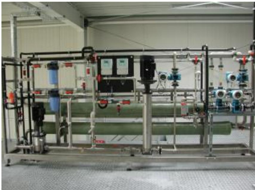
*Abbildung 8 Beispiel einer Nanofiltrationsanlage*
