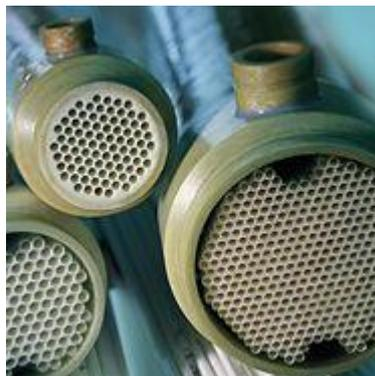
Abbildung 6 Cross-Flow Rohrmodule
