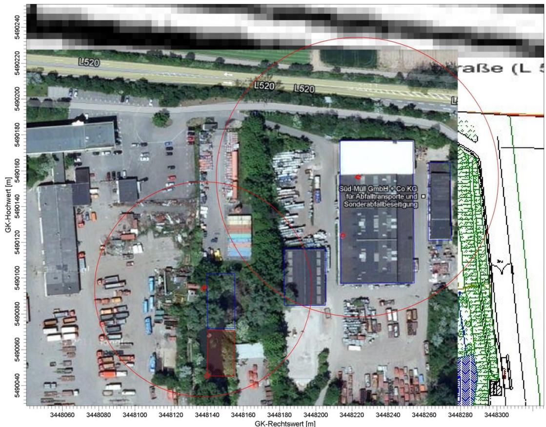
Abbildung 9. Darstellung der nach TA Luft notwendigen Bereiche, innerhalb derer Gebäude zu berücksichtigen sind (rote Kreise) sowie die tatsächlich berücksichtigten Gebäude (blau).
