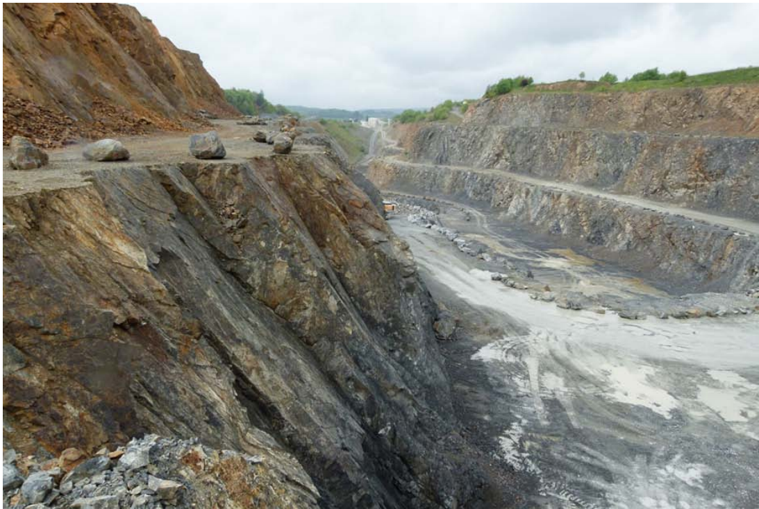
Abbildung 1-14: Ausgeprägte wandparallele Klüftung (SE-Wand, linke Seite) und in die Wand einfallende Klüftung (NW-Wand, rechte Seite); Blickrichtung SW
