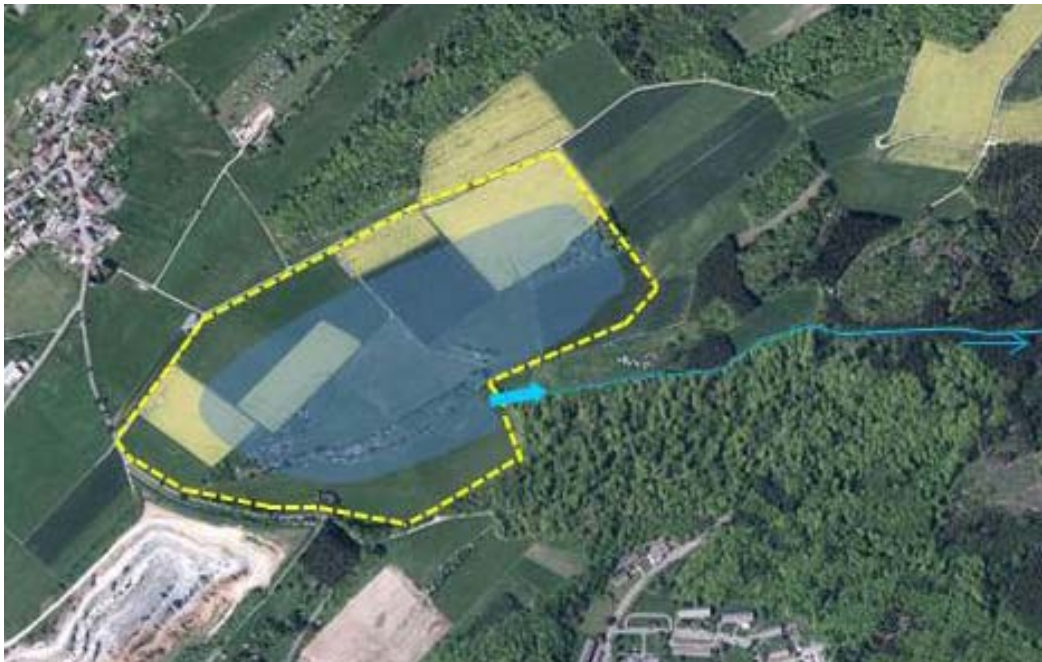
Abbildung 1-33: Projektion der Fläche des später entstehenden Sees mit Überlauf nach Osten zum Molkenbach hin
