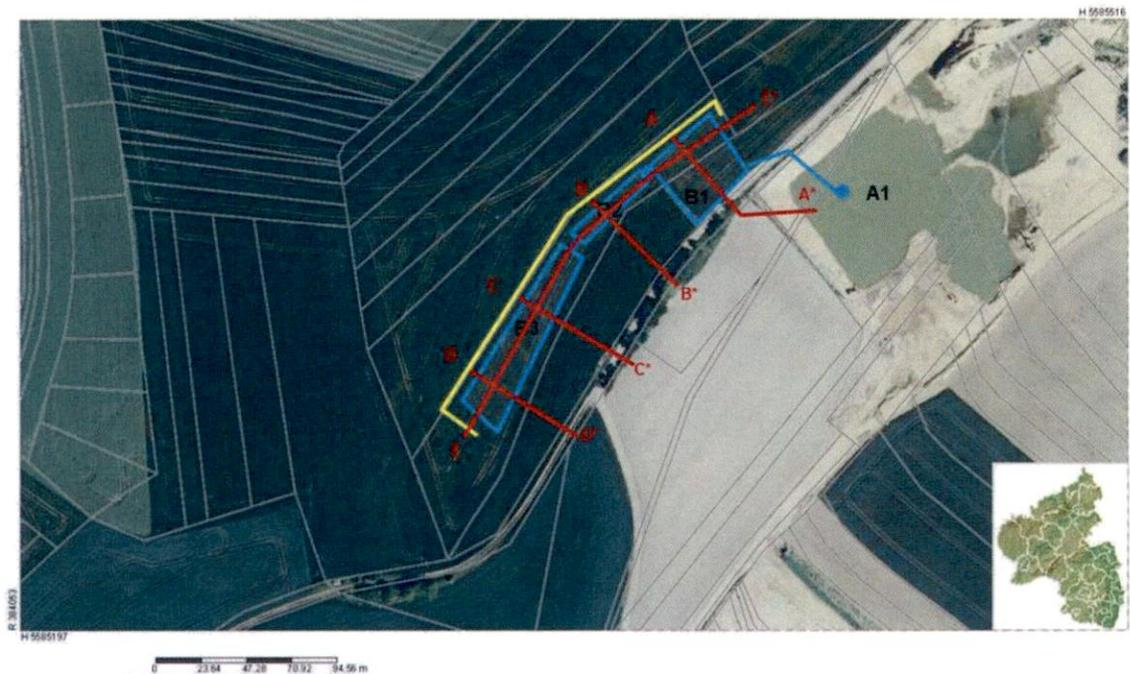
Abb. 12: Lage der neuen Becken mit Bestandsbecken A1 und Lage der Längs- und Querprofile.
