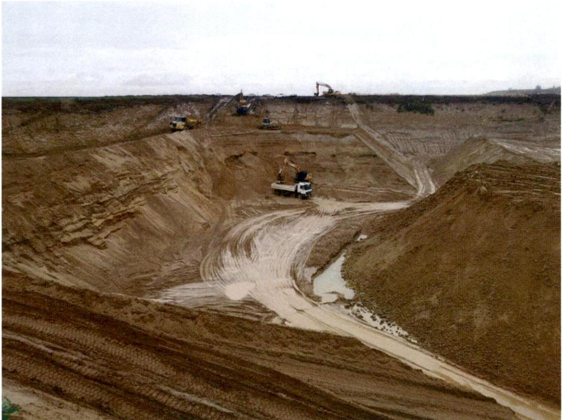
Abb. 10: Blick in den aktuellen Abbau, randlich auf der Tiefsohle ist der Sammelgraben für Oberflächenwasser sichtbar
