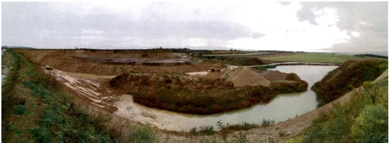
Abb. 11: Blick in den aktuellen Abbau, Die Tiefsohle ist mit einem leichten Gefälle und einem Randgraben angelegt, so dass der Abbau zum im Vordergrund liegenden Absetzteich und weiter in den Sammel- und Versickerungsteich entwässern kann
