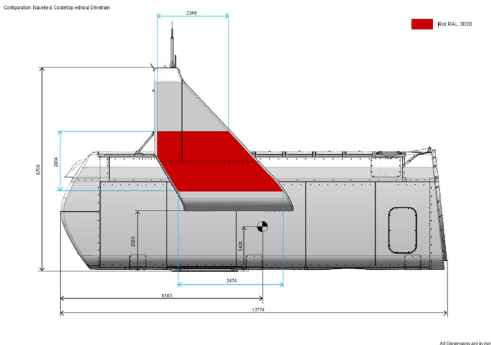
Vestas bestätigt hiermit die Konformität, der hier dargestellten und von Vestas ausgeführten Tageskennzeichnung Roter Streifen auf dem Maschinenhaus, mit der AVV Abschnitt 13.2.
