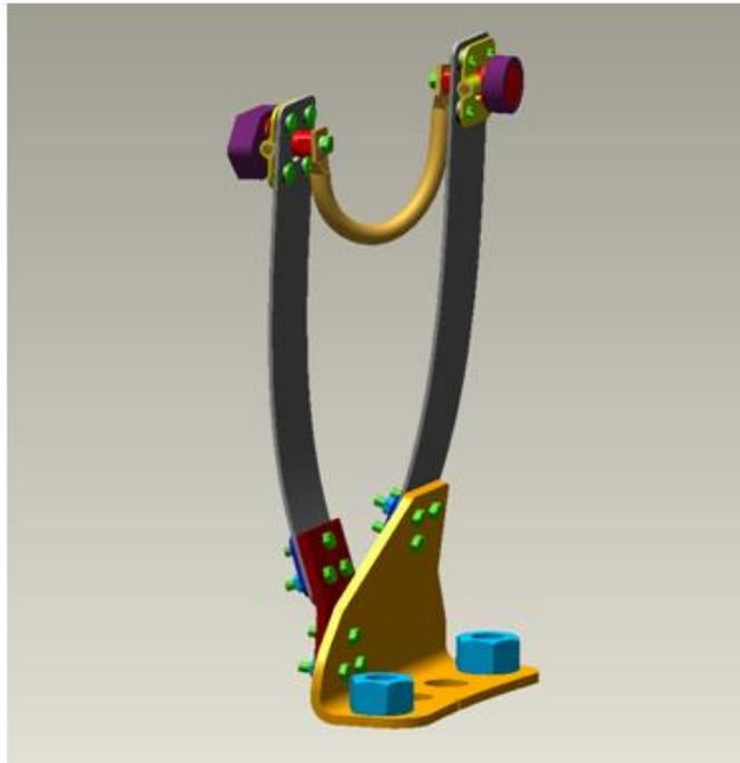
Abbildung 2-5: Blitzstrom-Übertragungseinheit zwischen Rotorblättern und Maschinenhausgehäuse
