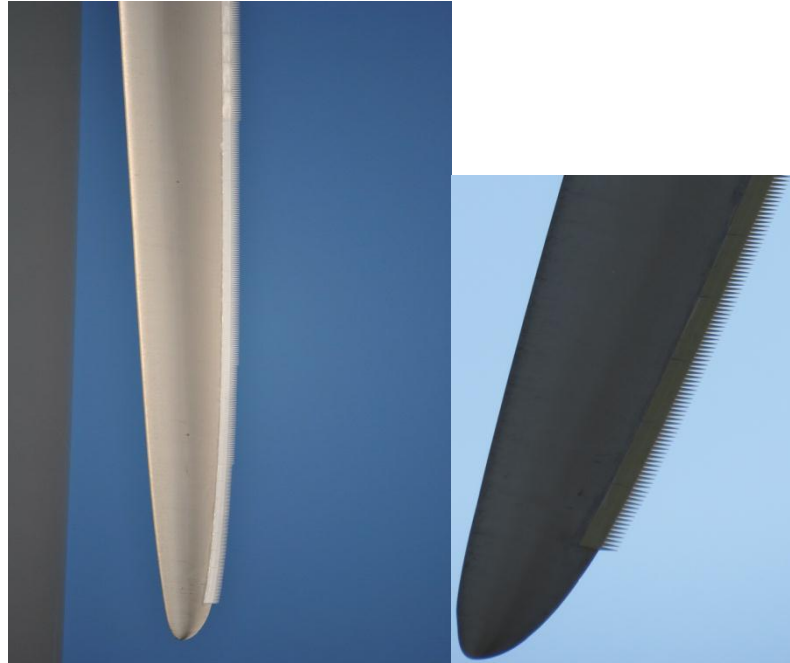
Abbildung1: Sägezahn-Hinterkante an Vestas-Windenergieanlagen
