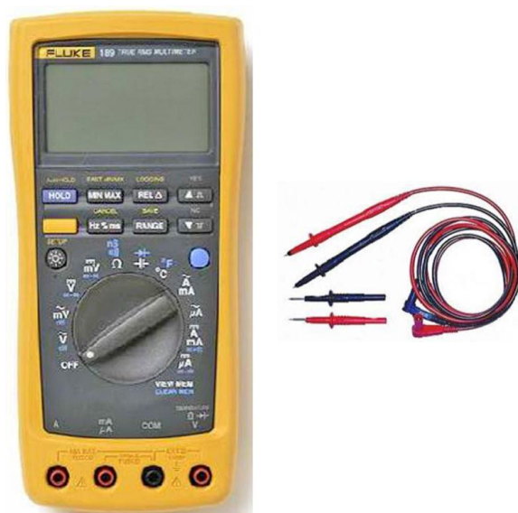
Abbildung 7-2: Prüfausrüstung (Multimeter mit Kabeln).
