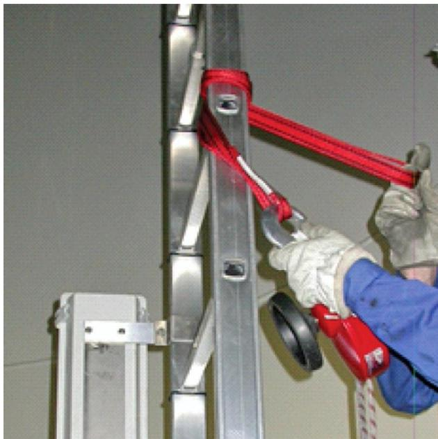
Abbildung 6-14: Befestigen der Abstiegsvorrichtung an der Leiter
