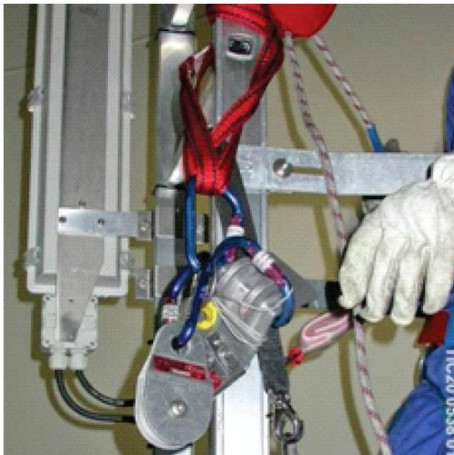
Abbildung 6-15: Befestigen der Teile der Abstiegsvorrichtung an der Leiter
