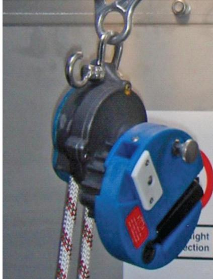
Abbildung 6-12: Seilsperre an der Abstiegsvorrichtung.
