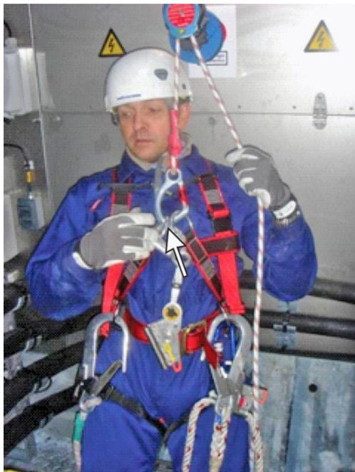
Abbildung 6-4: Befestigen der D-Ringe an der Abstiegsausrüstung.
