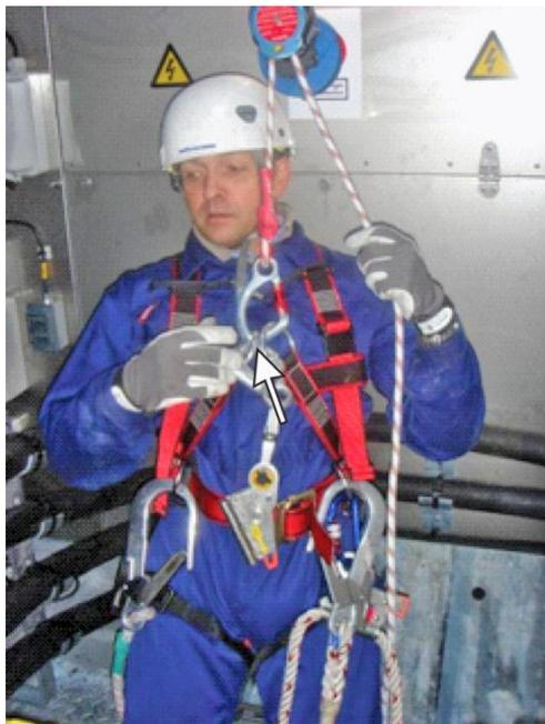
Abbildung 6-10: Befestigen von D-Ringen an der Abstiegsvorrichtung (Vorderseite).
