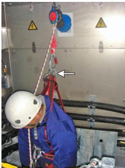
Abbildung 6-11: D-Ringe befestigt an der Abstiegsvorrichtung (Rückseite).
