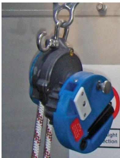
Abbildung 6-5: Seilsperre an der Abstiegsvorrichtung.
