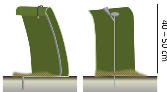
**Abb. 1** Beispielhafte Ausführungen von Reptilienschutzzäunen. Gebogene Ausführung mit Gummispannsystem (links) nach Fa. ACO Tiefbau Vertrieb GmbH, Rendsburg. Gewinkelte Ausführung mit Stecksystem nach Fa. MAIBACH Verkehrssicherheits- und Lärmschutzeinrichtungen
