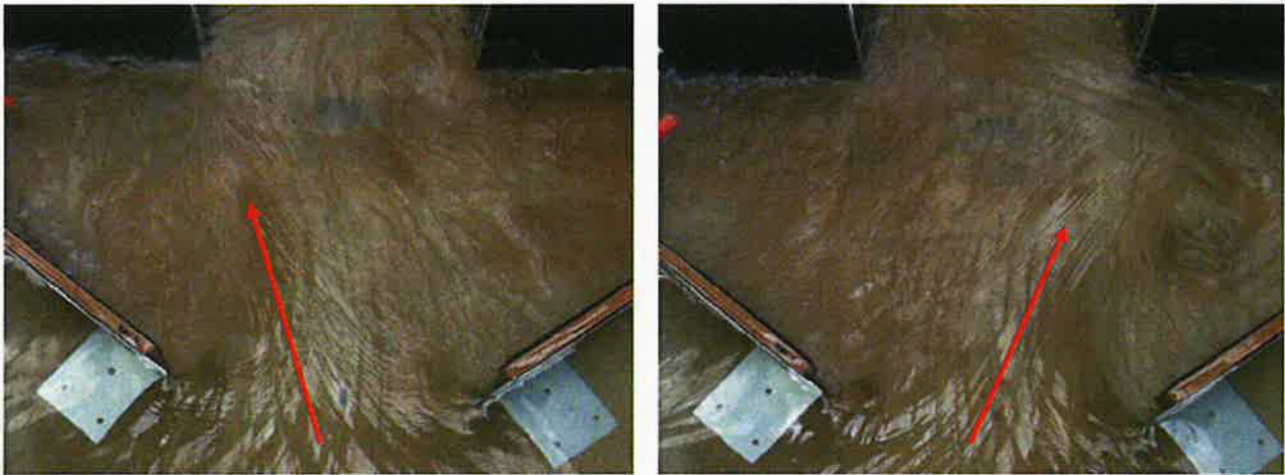
Abbildung 5-5: Turbulente Strömungssituation bei der Variante mit Spundwandvorbau (Darstellung zu zwei unterschiedlichen Zeitpunkten)
