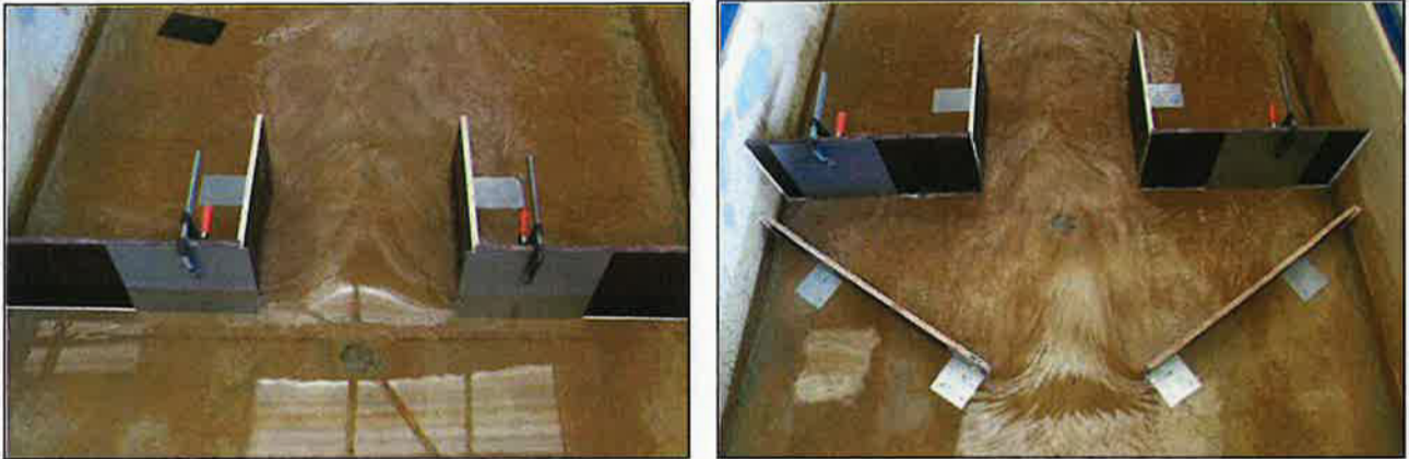
Abbildung 5-3: physikalisches Modell der Modellvarianten an der K13 (links: Blende im Brückenquerschnitt; rechts: Spundwandvorbau)
