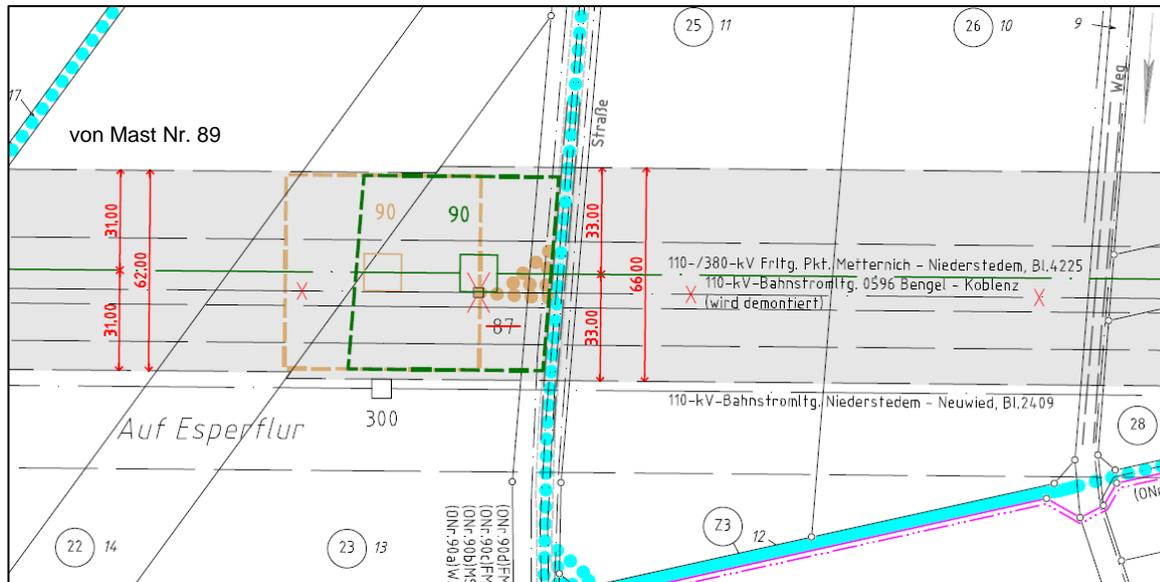
Abbildung 4: Lageplanausschnitt der Mastverschiebung Mast Nr. 90.
