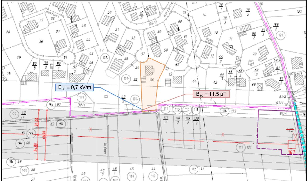
Orte der maximalen elektrischen Feldstärke  $E$  und magnetischen Flussdicht  $B$ .  $E_{50}$  und  $B_{50}$  bezeichnen die Maxima der 50-Hz-Komponenten gemäß Anlage 2a der 26. BImSchV.
