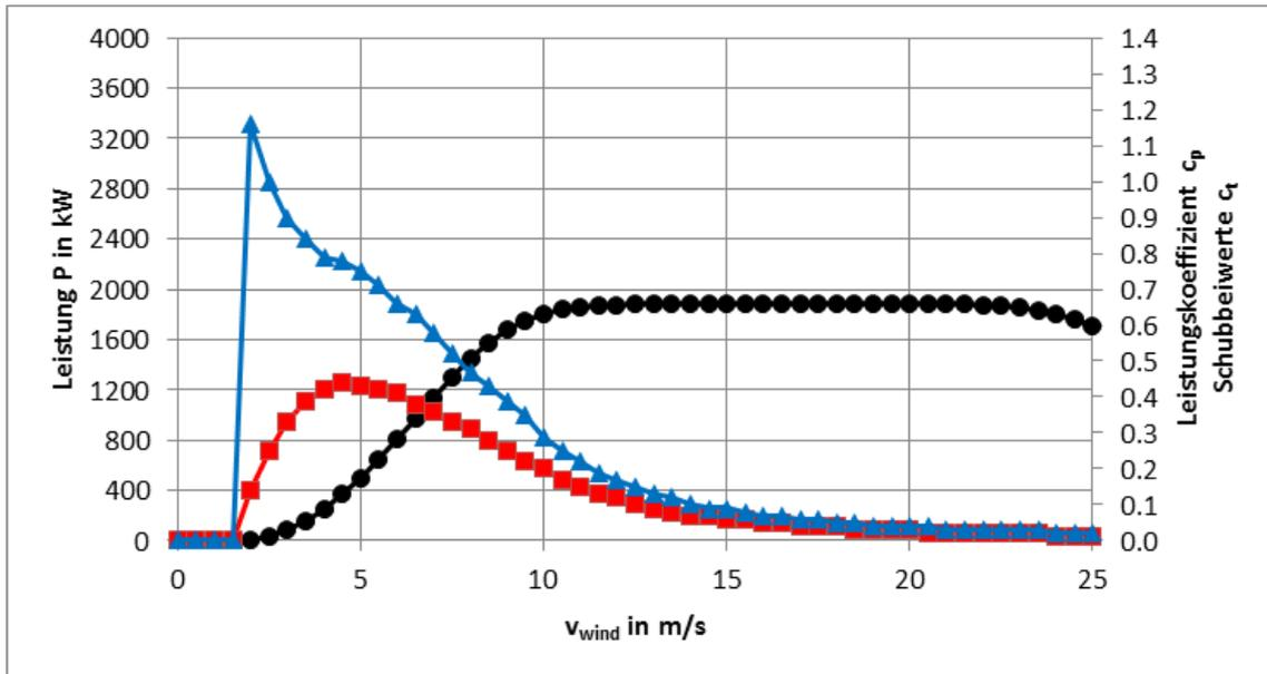
Abb. 2: Leistungs-,  $c_p$ - und  $c_t$ -Kennlinie E-138 EP3 / 3500 kW Betriebsmodus 99 dB
