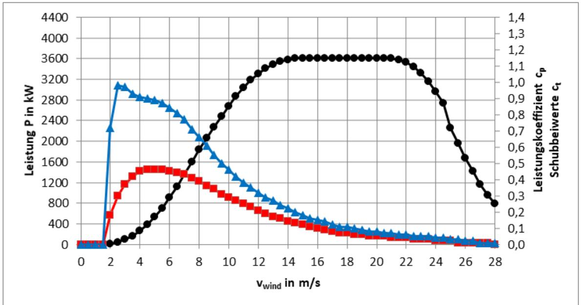
Abb. 1: Leistungs-,  $c_p$ - und  $c_t$ -Kennlinie E-138 EP3 E2 / 4200 kW Betriebsmodus NR 4
