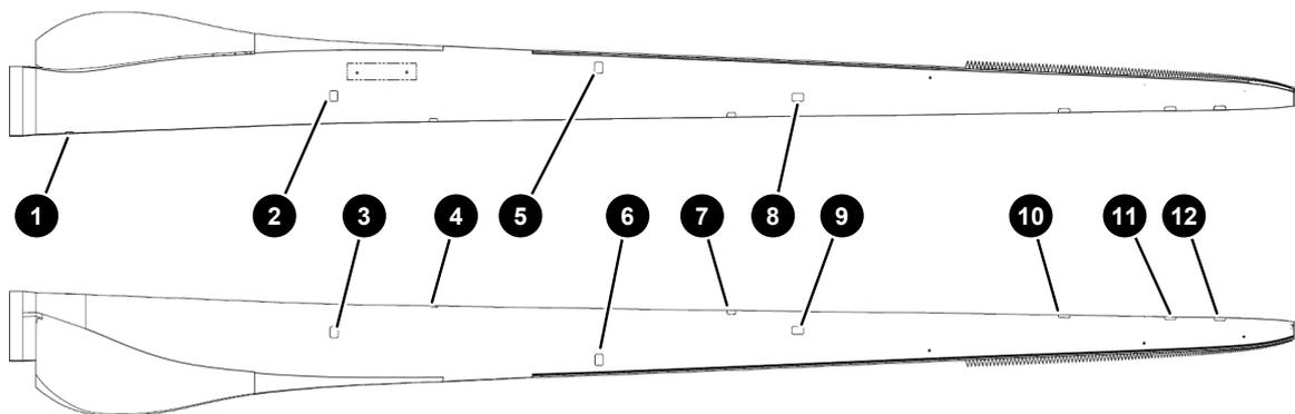
Abb. 4: Beispiel der Montageposition der Sensoren
