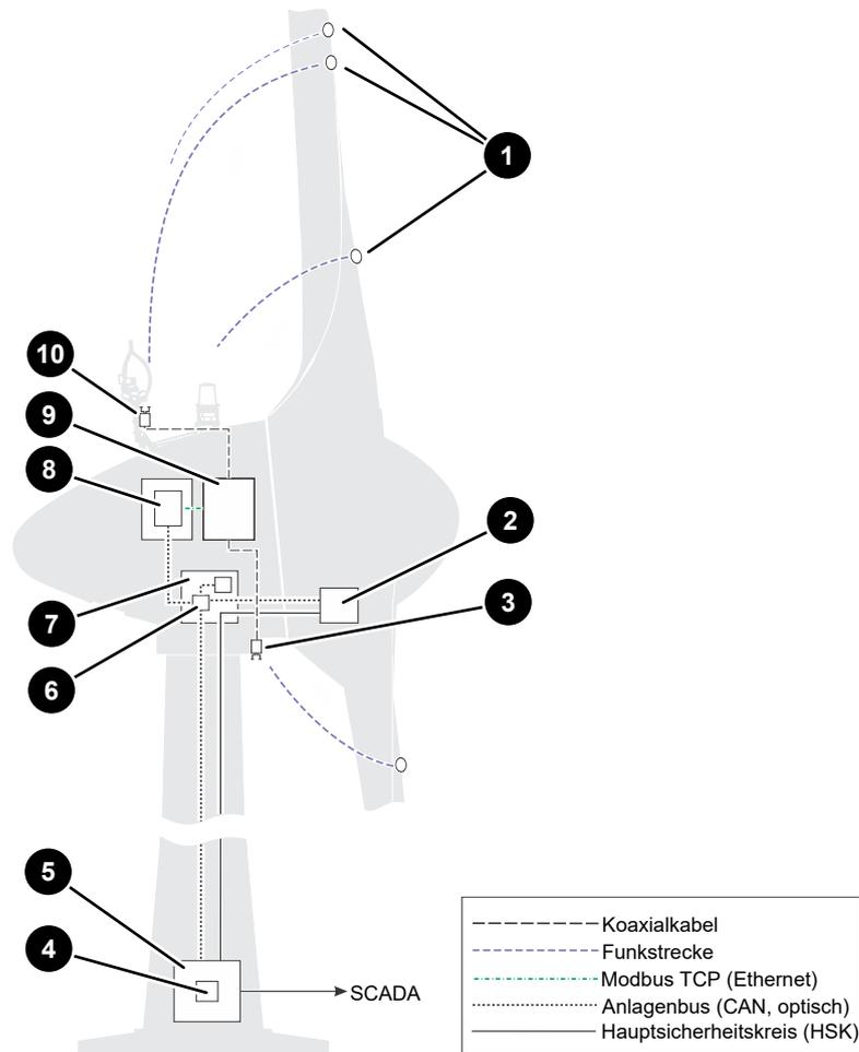
**Abb. 3: Baugruppenübersicht für die Einbindung des Eisansatzerkennungssystems in das Betriebsführungssystem**
