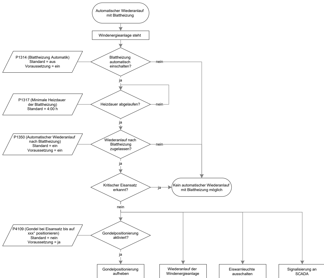
Abb. 3: Automatischer Wiederanlauf mit Blattheizung
