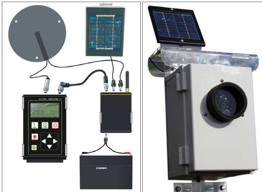
Abbildung 2.1: Außenansicht der Boxerweiterung mit Grenzflächenmikrofon und Solarpanel (links) und schematisierter Aufbau des verwendeten batcorder-Messsystems inkl. Box-Erweiterung (rechts) (Quelle: ecoObs GmbH).
