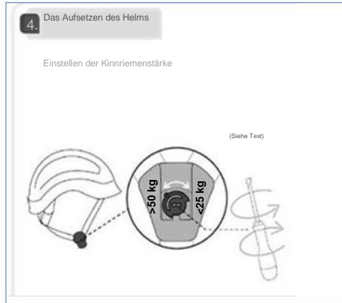
Abbildung 9.7 (a): Bild zur Änderung der Reißfestigkeit des Riemens
