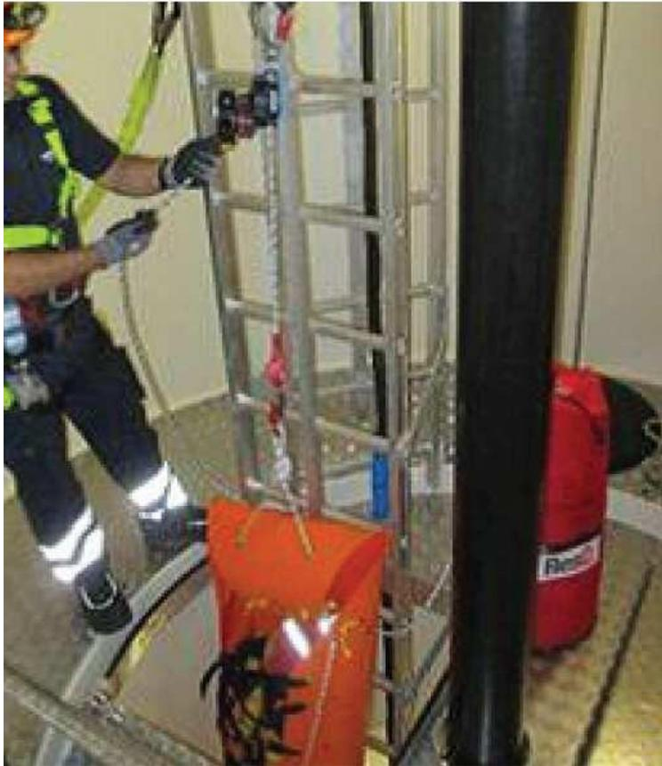
**Abbildung 5.23: Absenken der verletzten Person mithilfe der Abstiegsvorrichtung**
