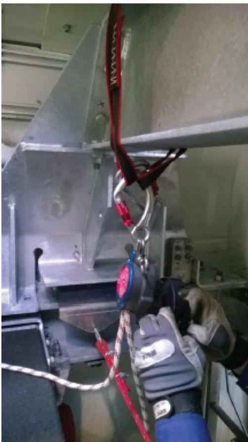
Abbildung 5.21: Am internen Ausleger befestigte Abstiegsvorrichtung
