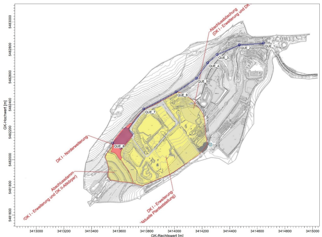
Abbildung 7. Lageplan der Emissionsquellen (blau) auf dem Betriebsgelände der ZAK.
