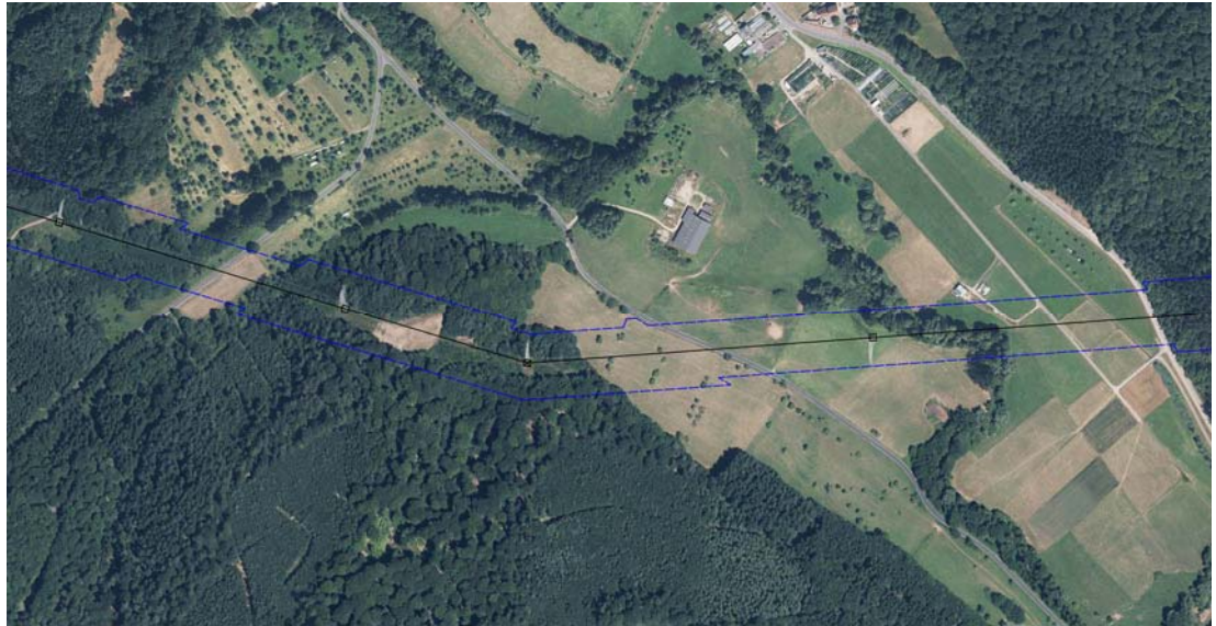
Abbildung 13: vorhandene Trasse der 220-kV-Höchstspannungsfreileitung Bl. 2409 südlich von Dreis
