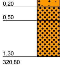
fS, mS, erdfeucht, leicht zu bohren, locker, Holz-, Wurzelreste, braun
