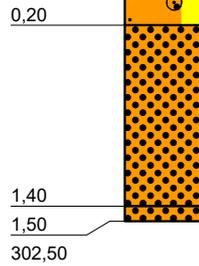
fS, mS, g, erdfeucht, leicht zu bohren, locker, Wurzelreste, braun
