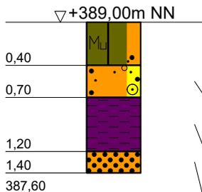
Mu, fs- ms, erdfeucht, leicht zu bohren, locker, Wurzelreste, braun
