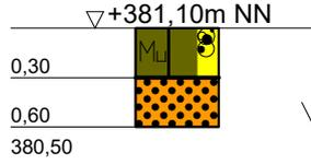
Mu, g, s', erdfeucht, locker bis mitteldicht,
