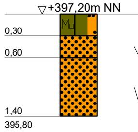
Mu, fs- ms, u', erdfeucht, leicht zu bohren, locker, Wurzelreste, rot
