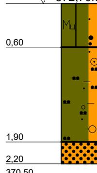
Mu, s, erdfeucht, schwer zu bohren, locker bis mitteldicht, braun
