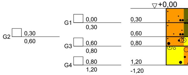
fS, u, h', schwach feucht, (OH), gerundet, bis 0,1 m Wurzelwerk, Wurzelreste, dunkelbraun
