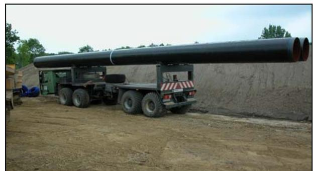
**Abbildung 4: Spezialfahrzeug Überkopflader**
