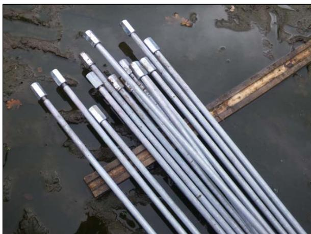
**Abbildung 7: Erderstahlstangen für Tiefenerder**
