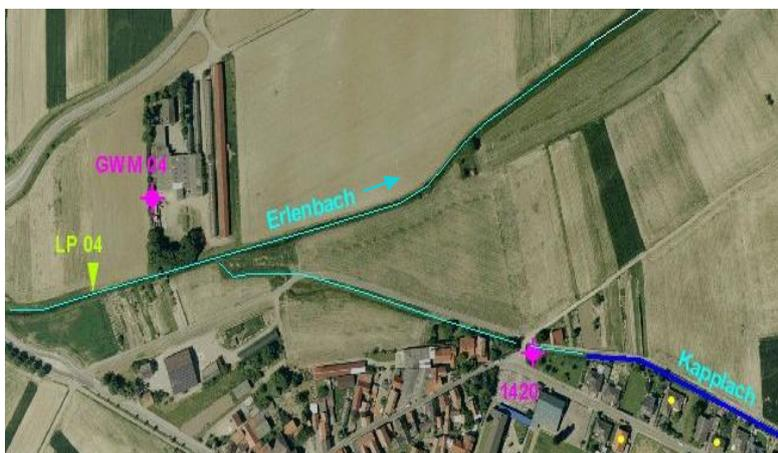
Hochlage des Erlenbachs deutlich (vgl. Abb. 2). Dadurch ist die Gewässersohle stark kolmatiert, so dass nur geringe Wasserraten dem Grundwasser zusickern.
