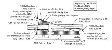
Sickerwasserpumpschacht, Schnitt A-A
