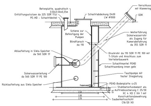
Sickerwasserpumpschacht, Schnitt B-B
