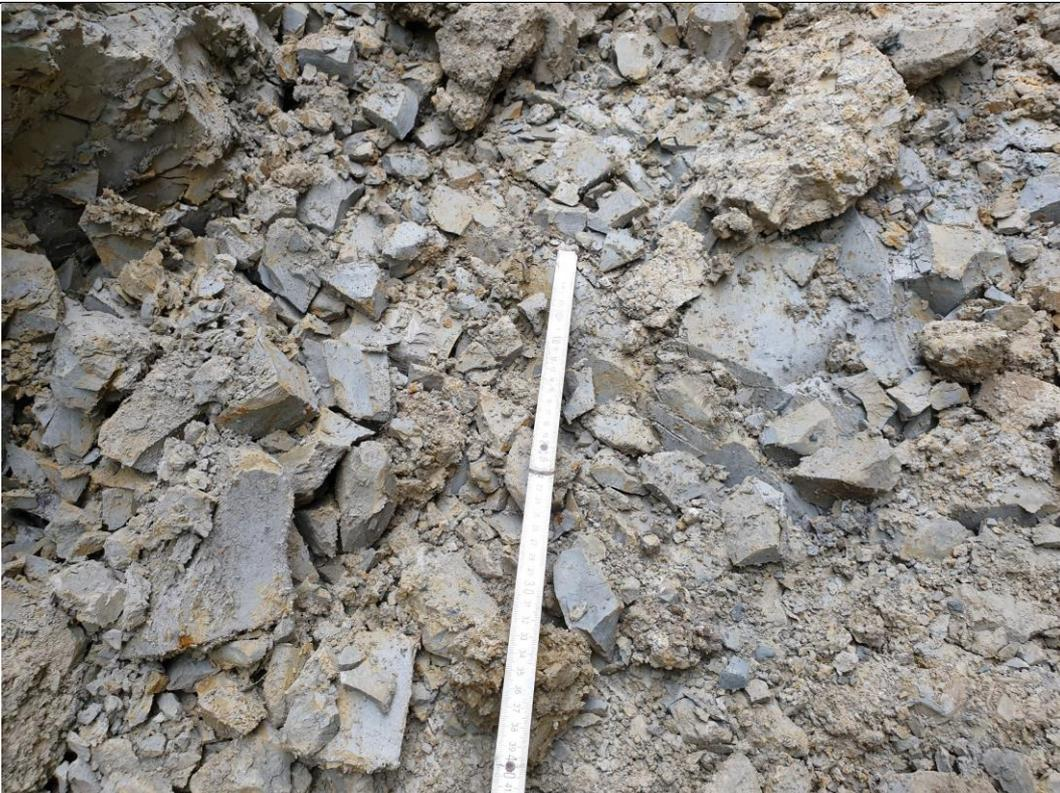
**Bild 14: Baggerschurf S4 / ZDA II.3 - Ton- / Kalkmergelstein (obere Osterwicker Schichten, oberes Unter-
