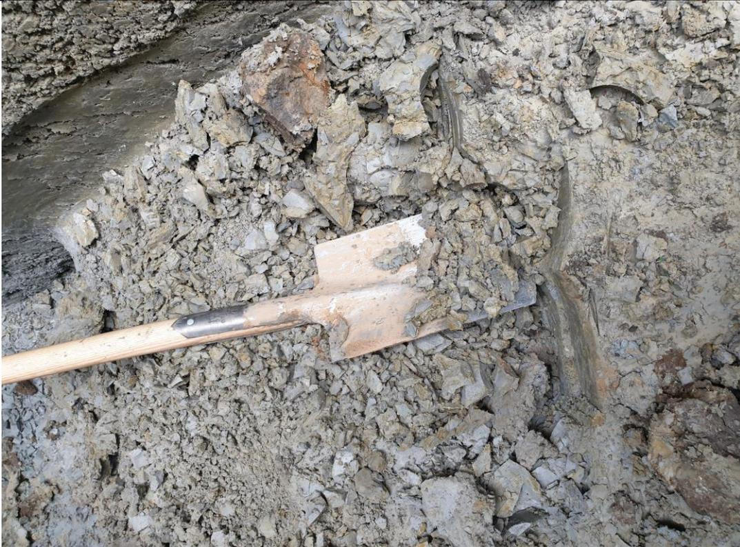
**Bild 3: Baggerschurf S1 / ZDA III - Ton- / Kalkmergelstein (obere Osterwicker Schichten, oberes Unter-campan)**
