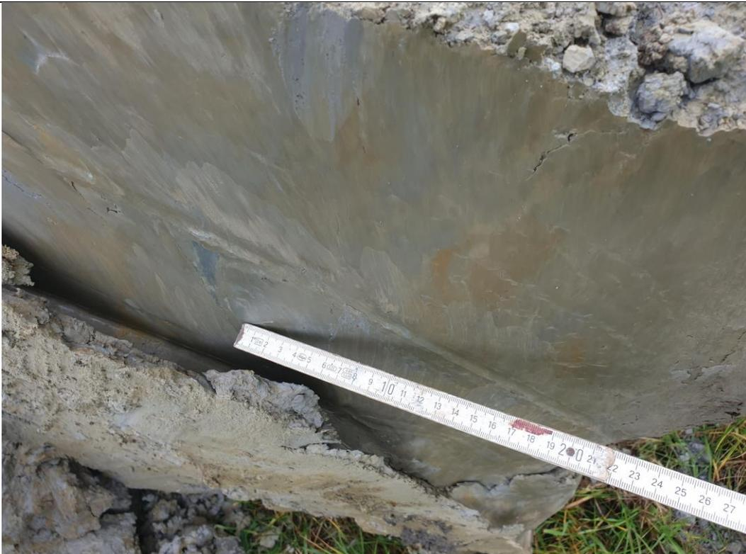
**Bild 2: Baggerschurf S1 / ZDA III - Mergel (Verwitterungszone obere Osterwicker Schichten, oberes Untercampan)**
