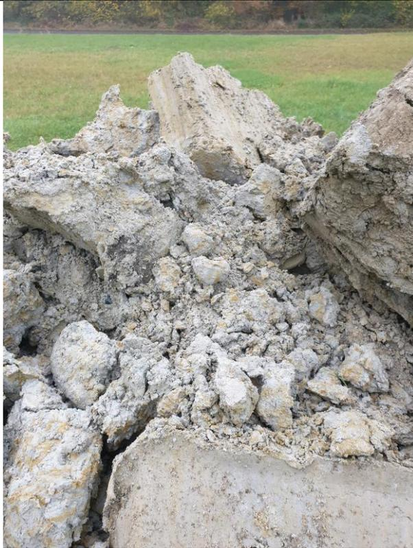
**Bild 5: Baggerschurf S1 / ZDA III - Mergel (Verwitterungszone obere Osterwicker Schichten, oberes Untercampan)**
