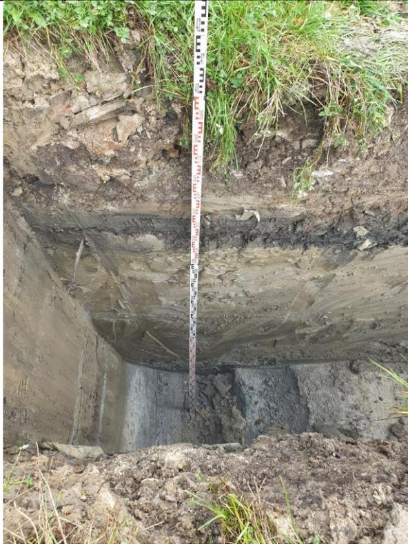
**Bild 1: Baggerschurf S1 / ZDA III - Profilschnitt**
