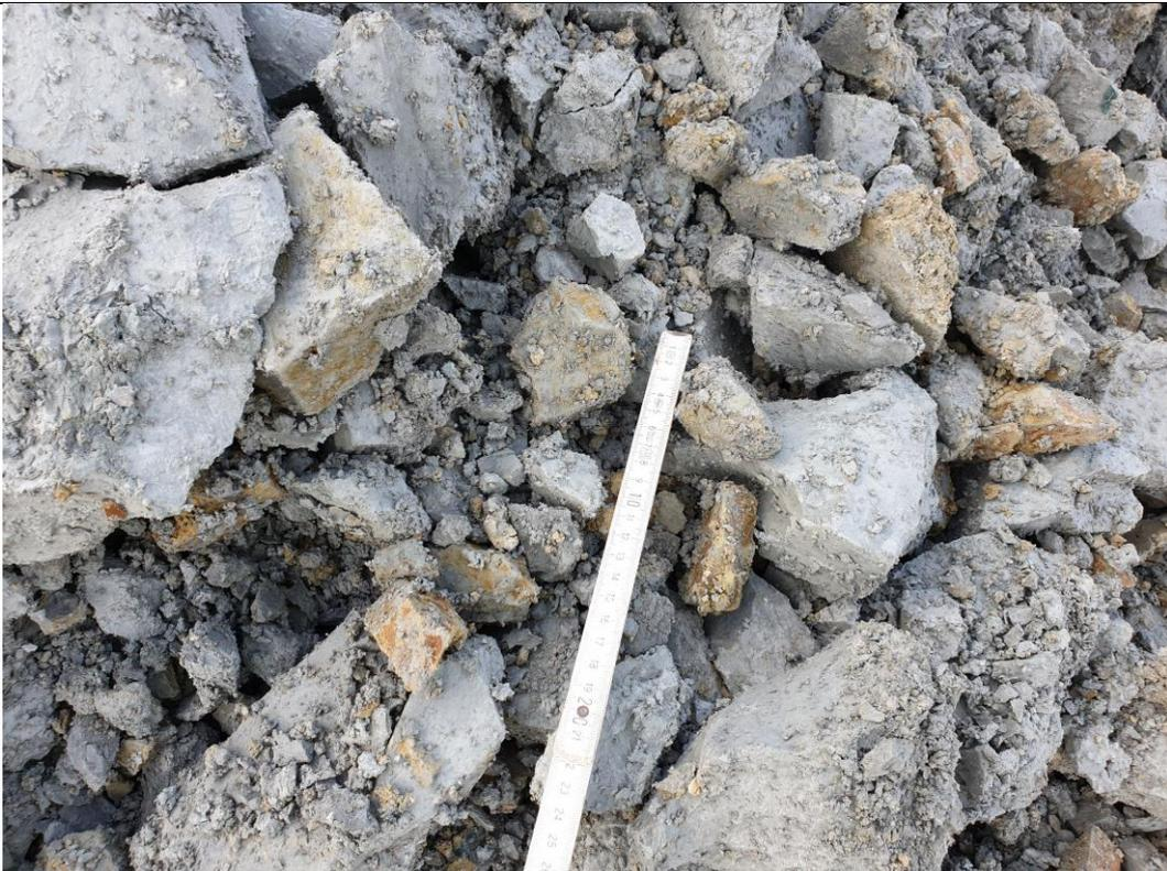
**Bild 10: Baggerschurf S3 / ZDA II.3 - Ton- / Kalkmergelstein (obere Osterwicker Schichten, oberes Untercampan)**
