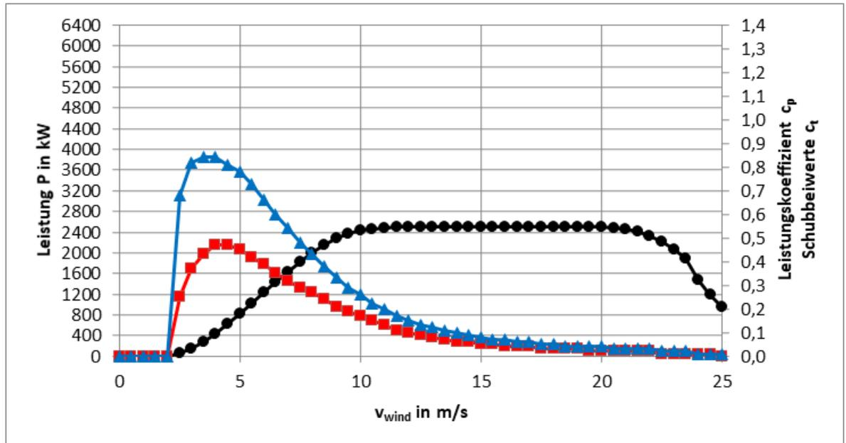
Abb. 1: Leistungs-,  $c_p$ - und  $c_t$ -Kennlinien E-175 EP5 E1 / 6000 kW Betriebsmodus OM-NR-07-0
