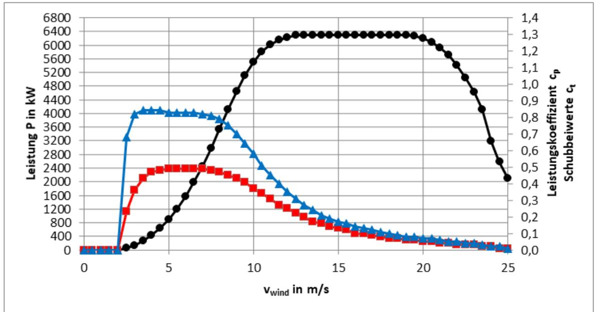
Abb. 1: Leistungs-,  $c_p$ - und  $c_t$ -Kennlinien E-175 EP5 / 6000 kW Betriebsmodus OM-YO-12-0
