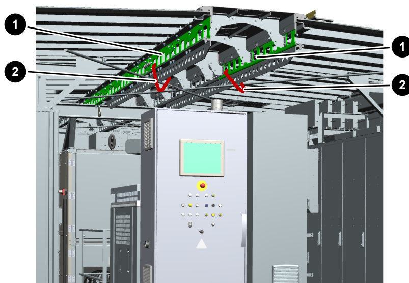
Abb. 3: Befestigungspunkte an den Dachtragschienen (Beispiel)
