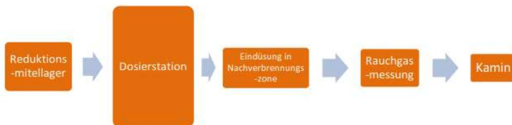
Das Reduktionsmittel wird mit einer Tauchpumpe zur Dosierstation gepumpt. Überschüssiges Reduktionsmittel wird über ein Druckregelventil in den Tank zurückgeführt. Somit wird ein konstanter Netzdruck des Reduktionsmittels gewährleistet.
