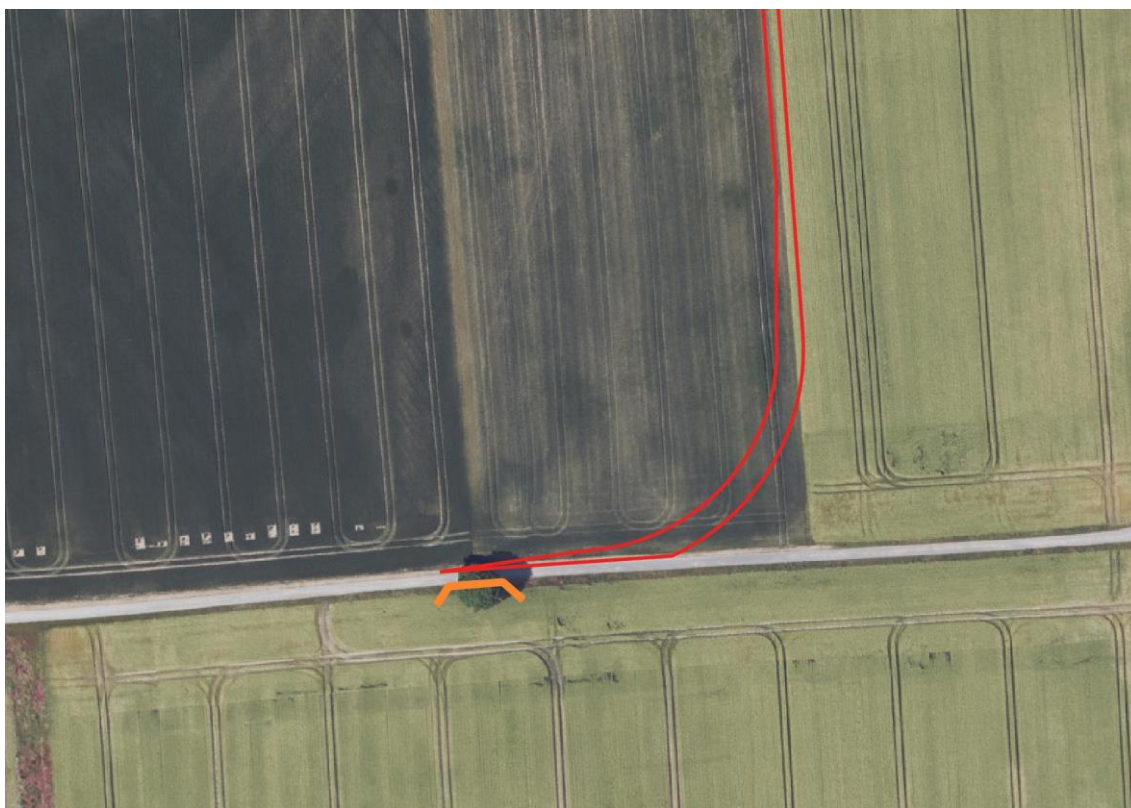
Abb. 7 Schutz des Einzelbaums während der Bauphase durch einen Zaun (orange Linie).
