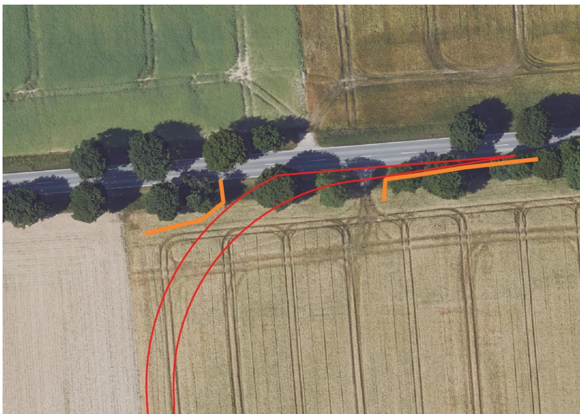
Abb. 6 Schutz der Einzelbäume während der Bauphase durch einen Zaun (orange Linie).
