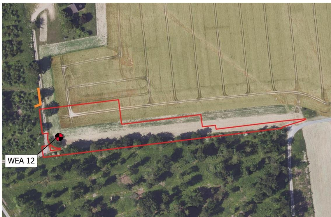
Abb. 10 Schutz von Einzelbäumen während der Bauphase durch einen Zaun (orange Linie).
