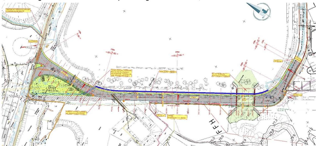
Abb. 2: Trassierung der neuen Zufahrt (Stand Entwurfsplanung) mit einer Grünbrücke als Anbindung an das FFH-Gebiet
