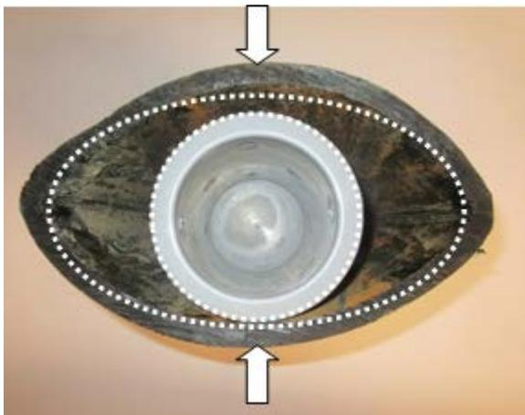
Abbildung 21: Beispiel für ein linienlagerungstaugliches Rohr in einem verformten PE-Rohr /17/
