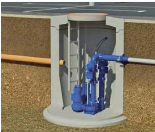
Abbildung 3: Beispiel-Darstellung Pumpwerk für die Sicherstellungsfläche
