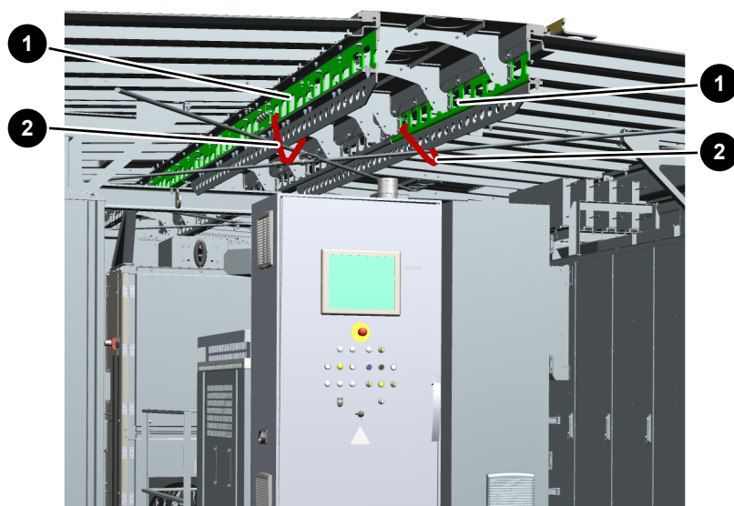
Abb. 3: Befestigungspunkte an den Dachtragschienen (Beispiel)
