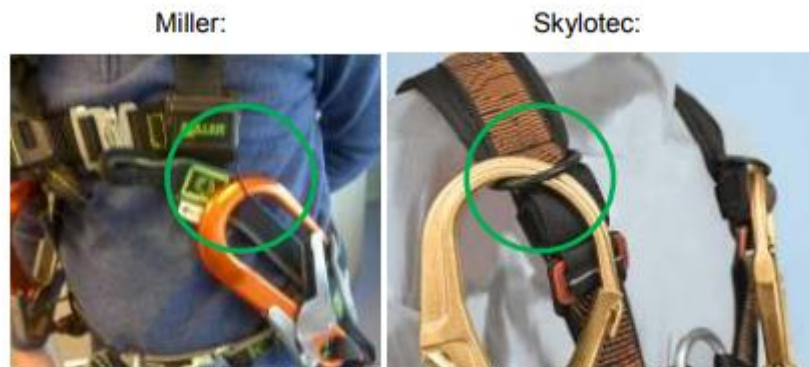
Abbildung 9-6: Befestigung der Ankerverbindung am Auffang- und Rettungsgurt
