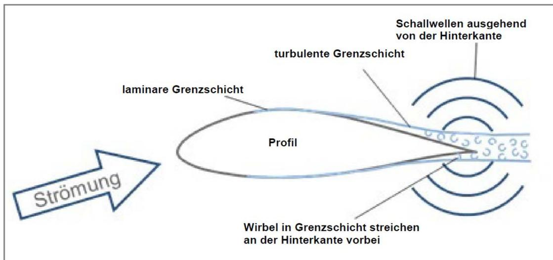
Abb. 1: Skizze zur Entstehung Hinterkantenschall am Rotorblattprofil
