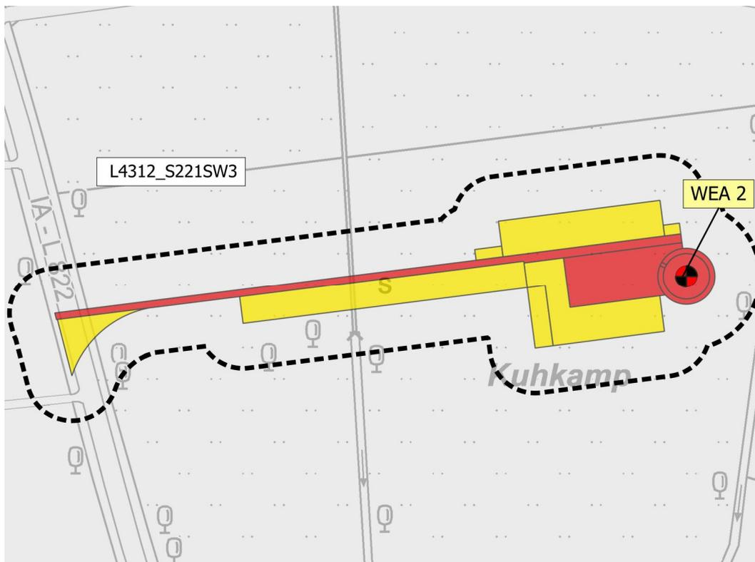
Abb. 16 Bodentypen im Bereich der geplanten WEA 2 (rot-schwarzer Kreis) und der Nutzflächen (rot = dauerhaft, gelb = temporär) gem. Bodenkarte BK 50 (WMS-FEATURE 2024) im Untersuchungsgebiet 25 m (schwarze Strichlinie).
