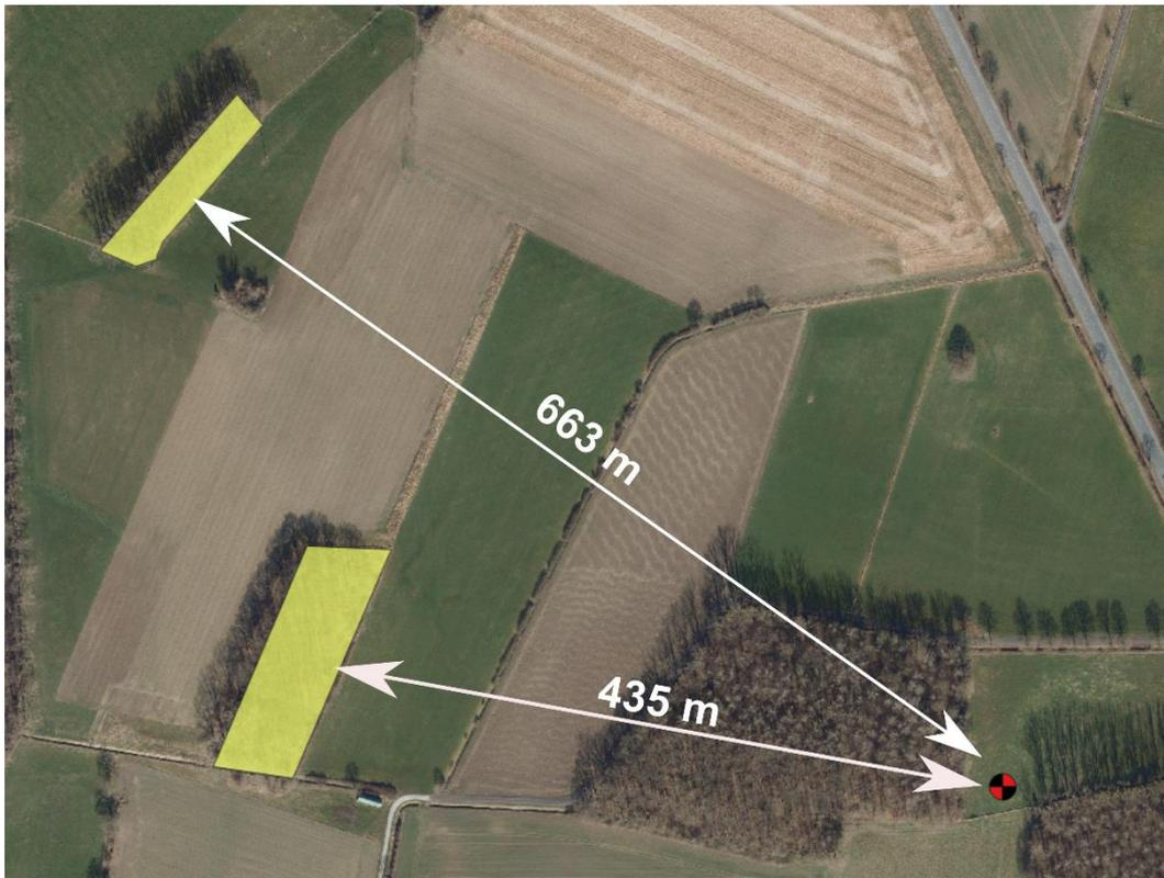
**Abb. 10** Darstellung der Lage der zu sichernden Gehölze zum geplanten WEA-Standort 1 auf Basis des DOP NRW.
