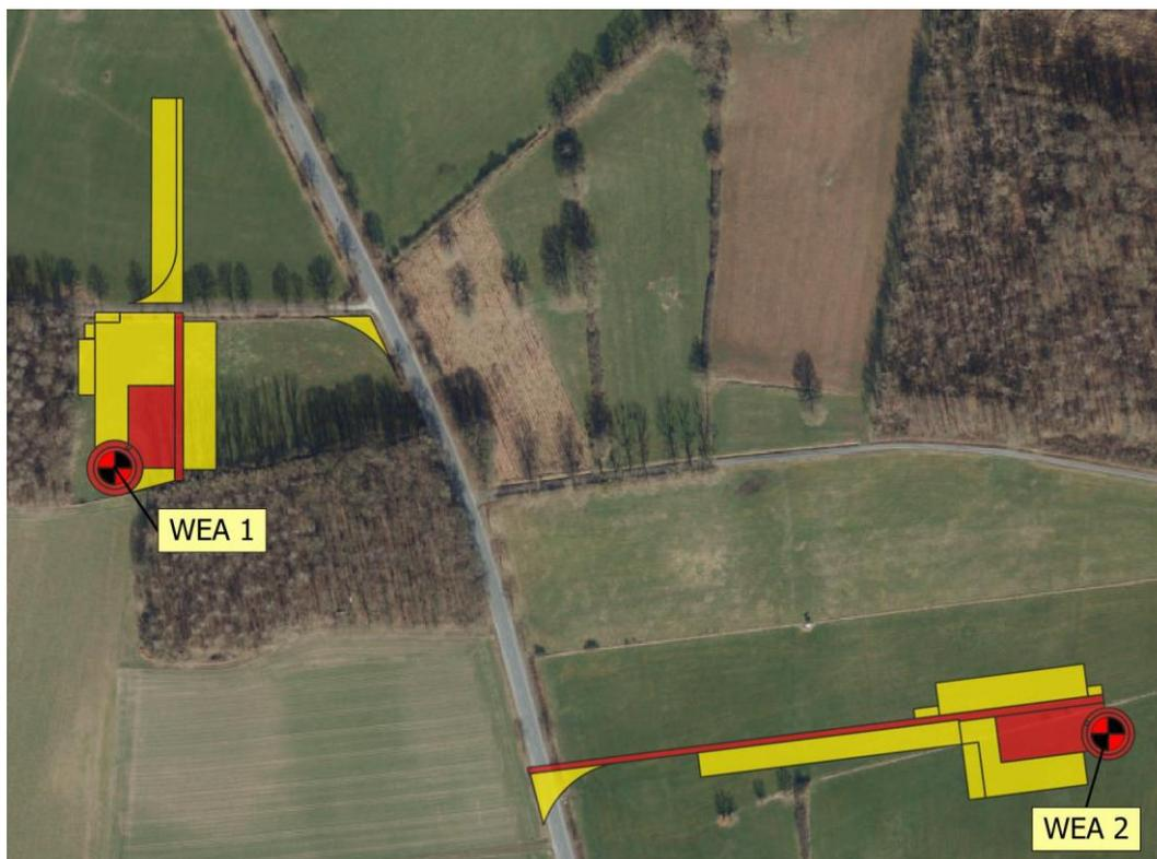
**Abb. 2** Darstellung der Anlagenstandorte (rot-schwarze Kreise) sowie der dazugehörigen Nutzflächen (dauerhaft = rote Flächen, temporär = gelbe Flächen).
