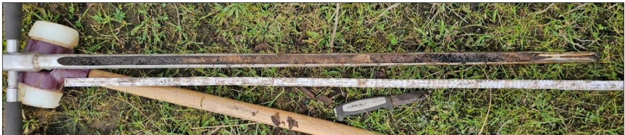
Abbildung 23: Durchmischter Sandboden (fS,ms) mit einer Lage Glassplitt in ca. 73 cm Tiefe (S25)
