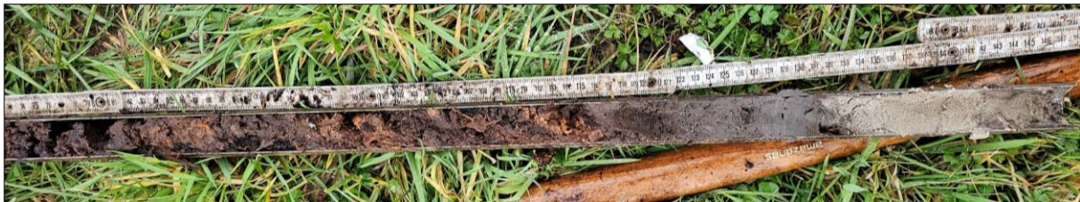
Abbildung 16: Torfauflage von über 1 m im Norden; deutliche Lehmschicht (Lts) am Übergang zum Mineralboden (S02)
