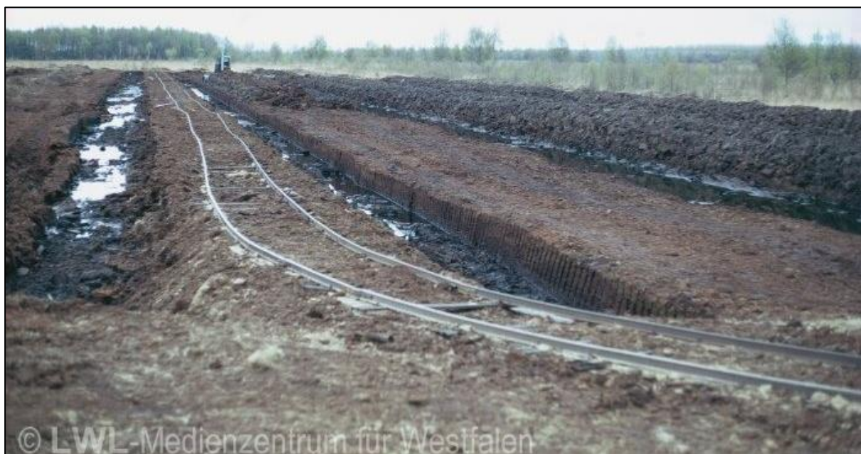
Abbildung 7: Im Amtsvenn: Schienentrasse der Feldbahn zum Abtransport des gestochenen Torfes. Dieses Foto zeigt den Ursprung der Sodentorstichstrukturen: in den tiefergelegenen Bereichen wurde bereits Torf gestochen, in den stehengebliebenen Torfbänken noch nicht. (© LWL-Medienzentrum für Westfalen)
