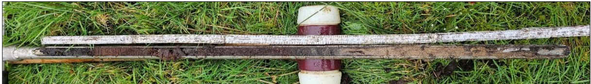
Abbildung 17: Torfauflage über humusarmen mittelsandigem Feinsand (S14).
