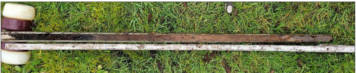
Abbildung 20: Geringmächtige Torfauflage über reliktschem Podsol (S13), im untere Profilabschnitt findet sich Lehm.
