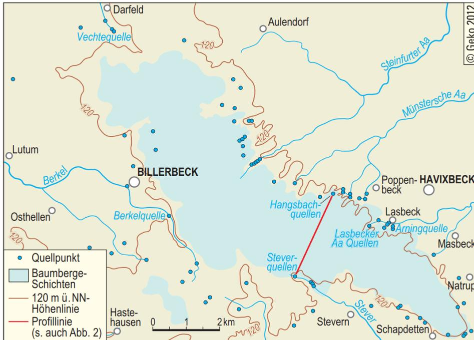
Abb. 2.3: Quellpunktelage in Bezug zur 120 mNN-Höhenlinie an der Untergrenze der Baumbergeschichten
